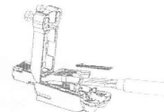
2. Führen Sie die Drähte in die Kontaktelemente des FC RJ-45-Steckers bis zum Anschlag ein.
