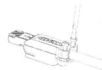
4. Schließen Sie den Stecker und ziehen Sie die Schrauben mit einem Schraubendreher 3,3mm bis zum Anschlag an.
