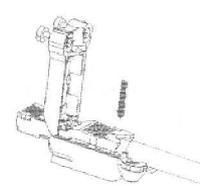
3. Drücken Sie auf die Kontaktelemente bis zum Anschlag um eine komplette Kontaktierung der Drähte zu realisieren.
